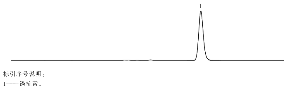
图 1 S-诱抗素可溶液剂的高效液相色谱图
